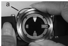
Fig. 164 - BATT O-RING
