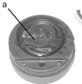
Fig. 115 - RETAINING BAR
